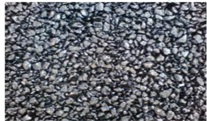
(d) PAC Surface after Compaction (Air Voids 25-30%)
