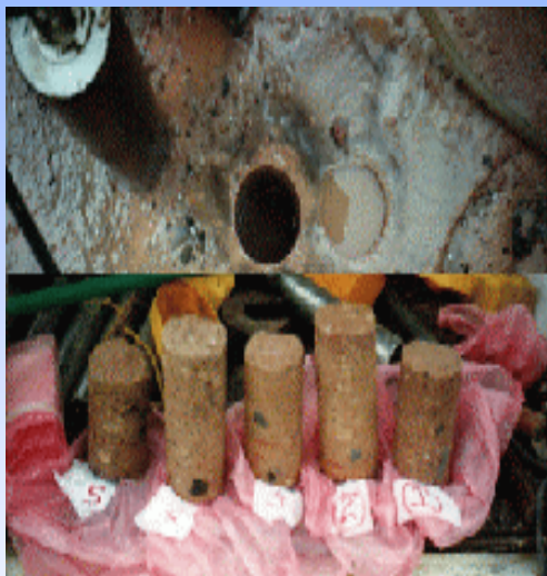
A) 现场钻探取样
